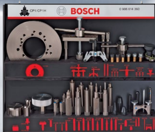
Oprava vysokotlakých čerpadel konstrukčních řad CP1 a CP1H
