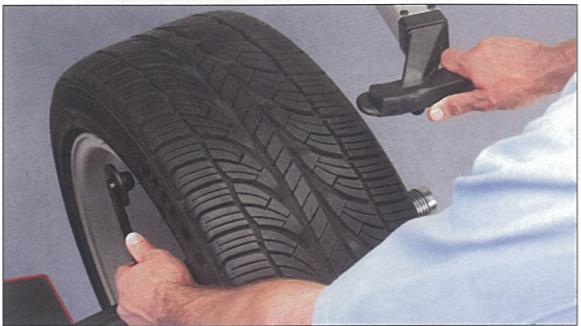
Vnitřní a vnější ramena Dataset urychlují zadání rozměrů kola a zvyšují přesnost osazení závaží.
