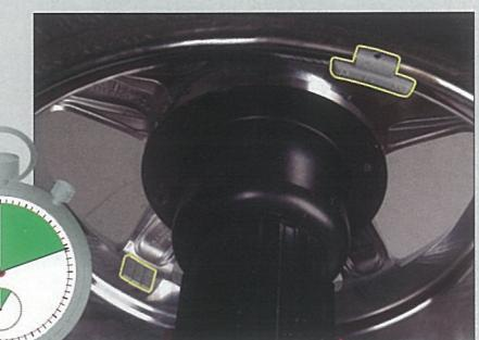
Vyvažování SmartSpoke spotřebuje až o 49 % méně vyvažovacích závaží a přispívá ke značné úspore potřebného času pro vyvažování.
