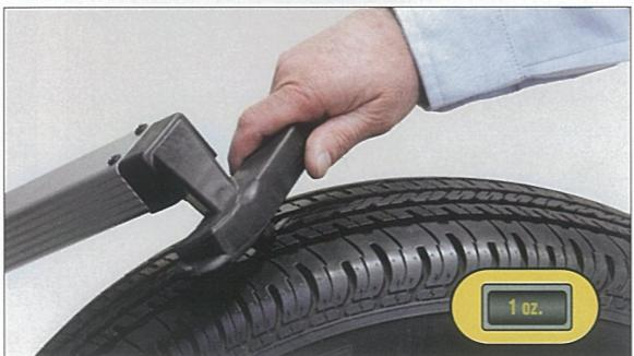
Perfektní funkce určená pro nadměrně velká kola a pneumatiky. Kola a pneumatiky terénních vozidel s pohonem 4x4 stále rostou z hlediska velikosti. Funkce Patch Balancing® řeší problémy s naklepávacími nebo lepenými závažími pomocí použití vyvažovacích vložek uvnitř pneumatik. Tak lze omezit nebo vyloučit závaží montovaná na ráfku a zvyšuje se zisk při vyvažování velkých kol, která jiní odmítají.
