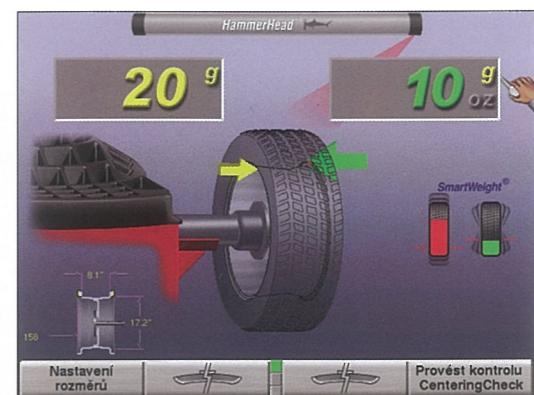
Po natočení kola do pozice pro umístění závaží se aktivuje laserový paprsek, který označuje přesnou polohu pro naklepávací závaží a zvyšuje počet kol vyvážených jedinou rotaci.
