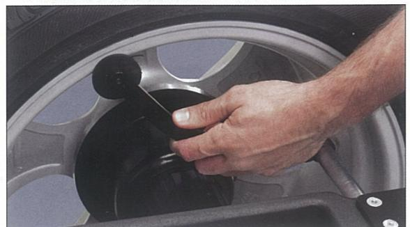
Vnitřní dotykové rameno Dataset® určuje přesné umístění závaží. Automaticky měří kola do průměru 762 mm.
