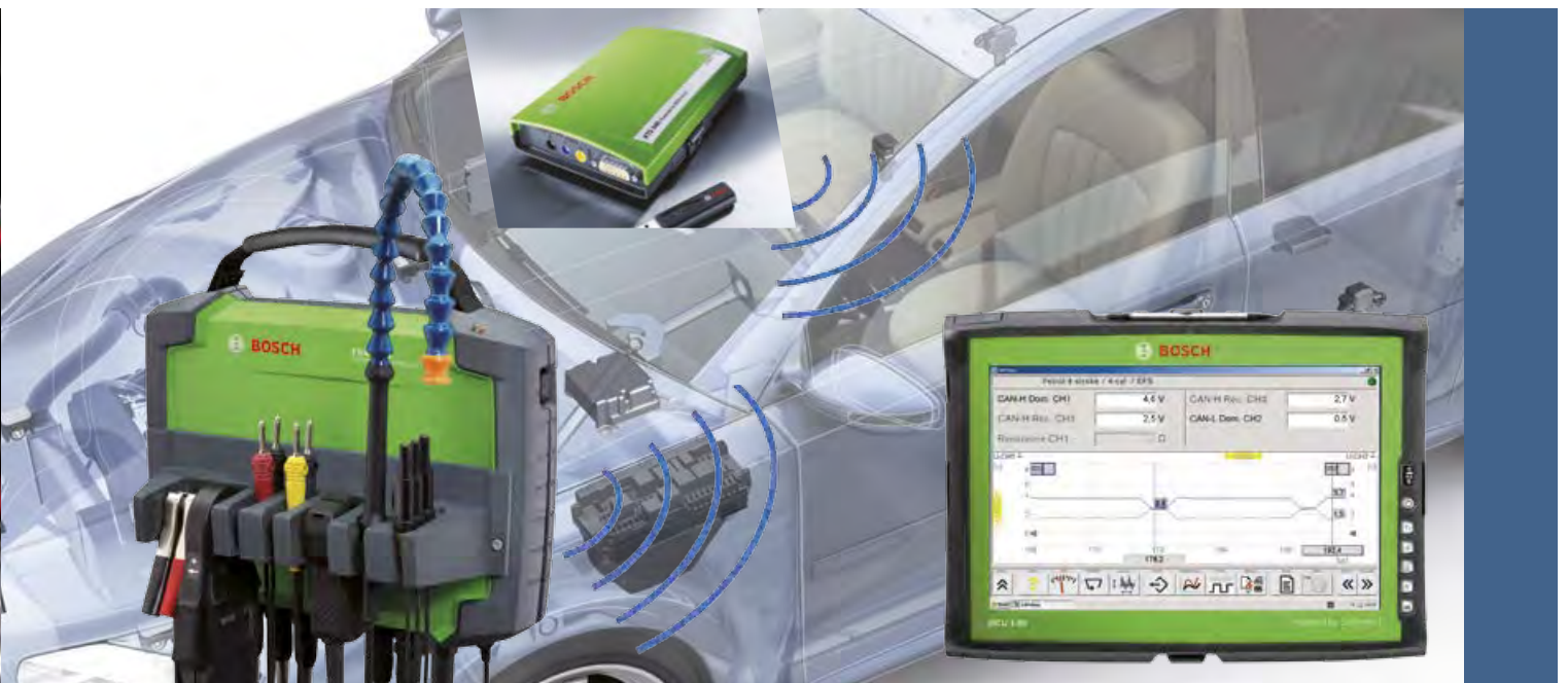
Výhodná modulární koncepce s rádiovým připojením k PC. Umístění modulu FSA 500 v motorovém prostoru, umístění modulu SD (KTS 5xx) v interiéru vozidla, komfortní připojení k vozidlu s krátkým vedením snímačů.
