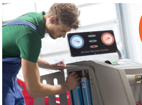
Štandard na jednotkách ASC 1300 G: systém skladovania a plnenia bez prístupu vlhkosti pre čerstvý olej a UV aditívum
