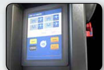
Ovládání na každém sloupu Integrované ovládání z každého sloupu
